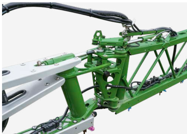
Шарнир с гидравлическим преднатяжением для отклонения крайней секции по принципу «салонной двери»
