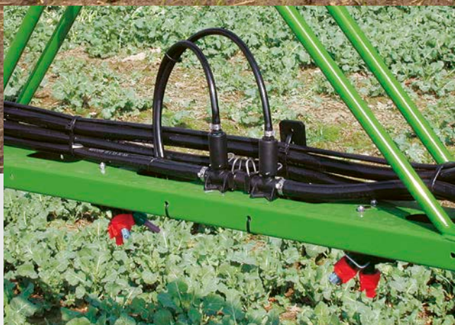
Система постоянной циркуляции (DUS)
