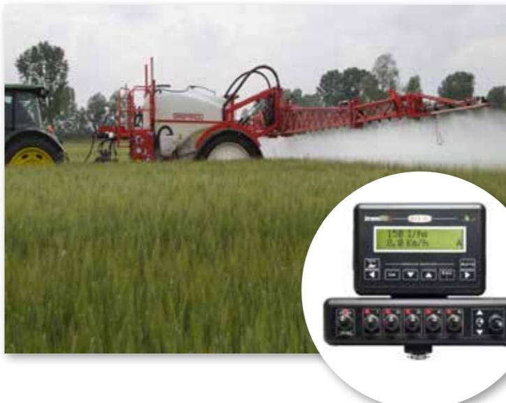
**Регулировка расхода в зависимости от скорости работы**
