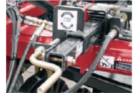
**Одноточечный механизм регулировки рабочей глубины.** Обеспечивает быструю и точную настройку агрегата для оптимальной подготовки почвы и заделки пожнивных остатков в широчайшем диапазоне рабочих условий.
