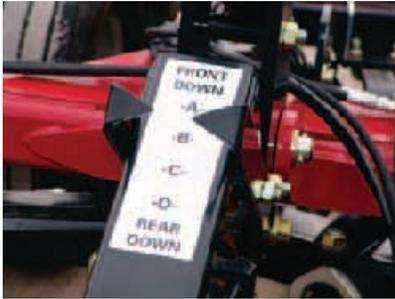
**Гидравлическая система выравнивания.** Обеспечивает совершенно однородную обработку почвы без образования гребней или борозд.
