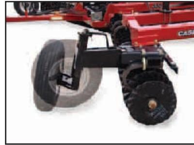
**Копирные колеса с ограниченным углом поворота.** Ограничение угла поворота копирных колес предотвращает их боковое скольжение на уплотненной поверхности почвы на поворотной полосе или в углах поля, позволяя выполнять развороты без излишней потери скорости.
