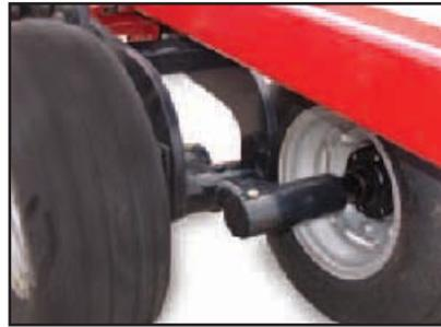
**Тандемные колеса с усиленными осями.** Позволяют агрегату работать на максимальной рабочей скорости даже в полях с неровным рельефом. Оптимальное расположение и балансировка колес обеспечивают равномерное рыхление и выравнивание поверхности почвы по всей рабочей ширине агрегата.
