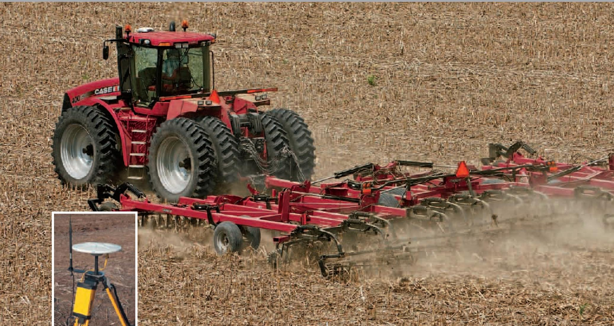
▲ Система автоматического вождения AFS ACCUGUIDE™ позволяет максимально увеличить производительность работы, обеспечивая возможность использования агрегата для вертикальной обработки почвы True-Tandem Turbo 330 на рабочих скоростях в 12-14,5 км/ч.
